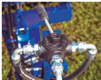
**Circuito Hidráulico:** equipado con válvula ecuencial y válvula divisora de flujo.
