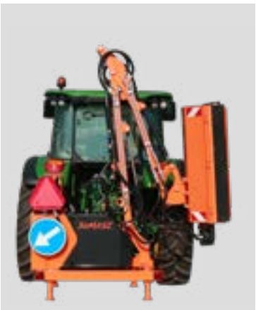
Unidad en posición de transporte - parachoques trasero con luces de carretera visibles.
