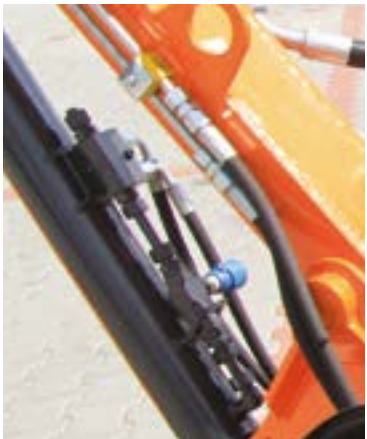
Bloqueo hidráulico en el cilindro principal junto con una válvula de cierre ajustable.
